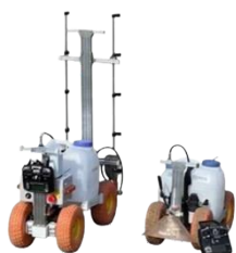
資材散布ロボット
