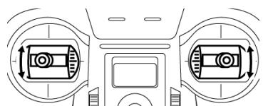
図のクローラースティックで本製品を走行させます。
