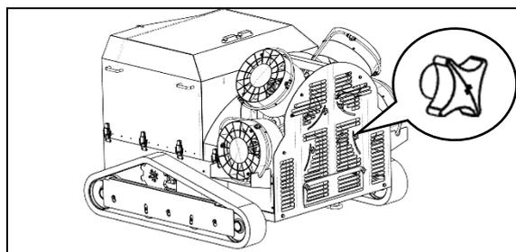
図の十字ノブを緩め左右に動かし、4つのファンの角度を調整して噴霧方向を調整して下さい。
